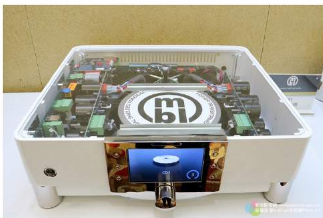
這是New Noble Line中的綜合擴大機NS1，可以看到內部紮實的結構。
