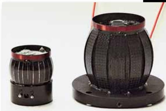
Die Radialstrahler für die Mitten und Höhen bestehen aus schmalen, steifen und mit einem Speziallack überzogenen Carbonstreifen, die von Schwingspulen verformt werden
